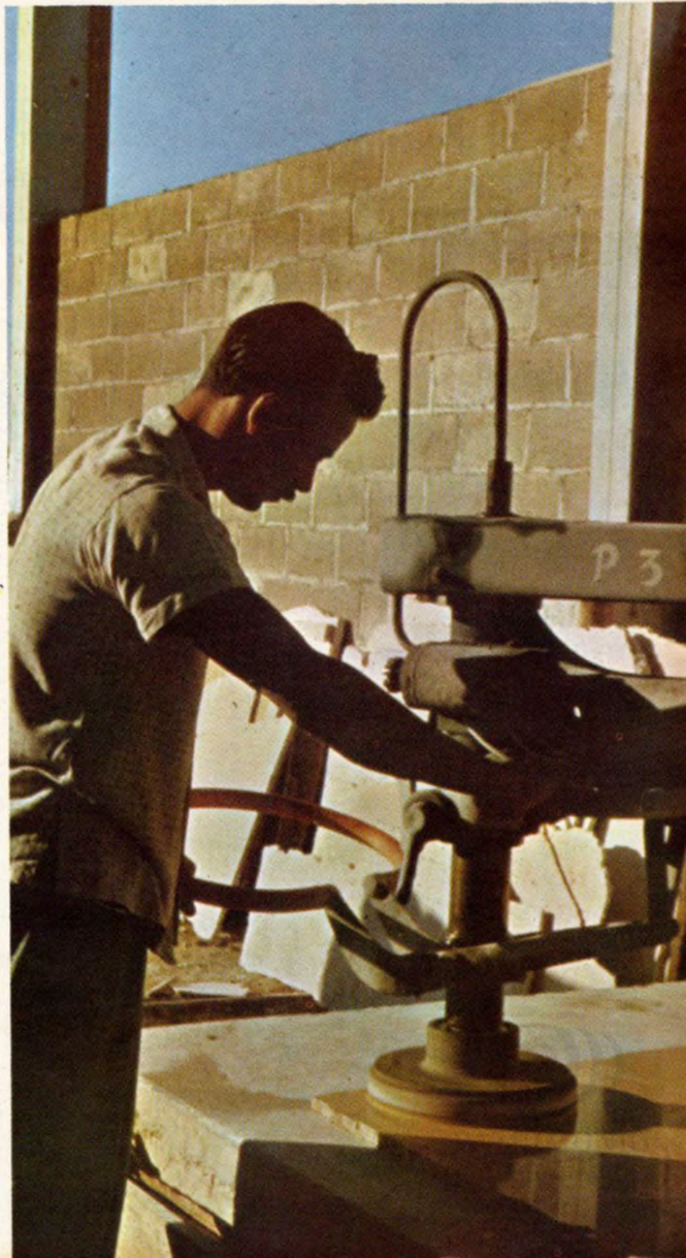
EL PULIDO DE LAS PLANCHAS, DEBIDO A LA ENORME DUREZA DE LOS MARMOLES CUBANOS, HACE QUE EL BRILLO DURE MUCHO MAS QUE EN LOS MARMOLES DE OTROS PAISES
