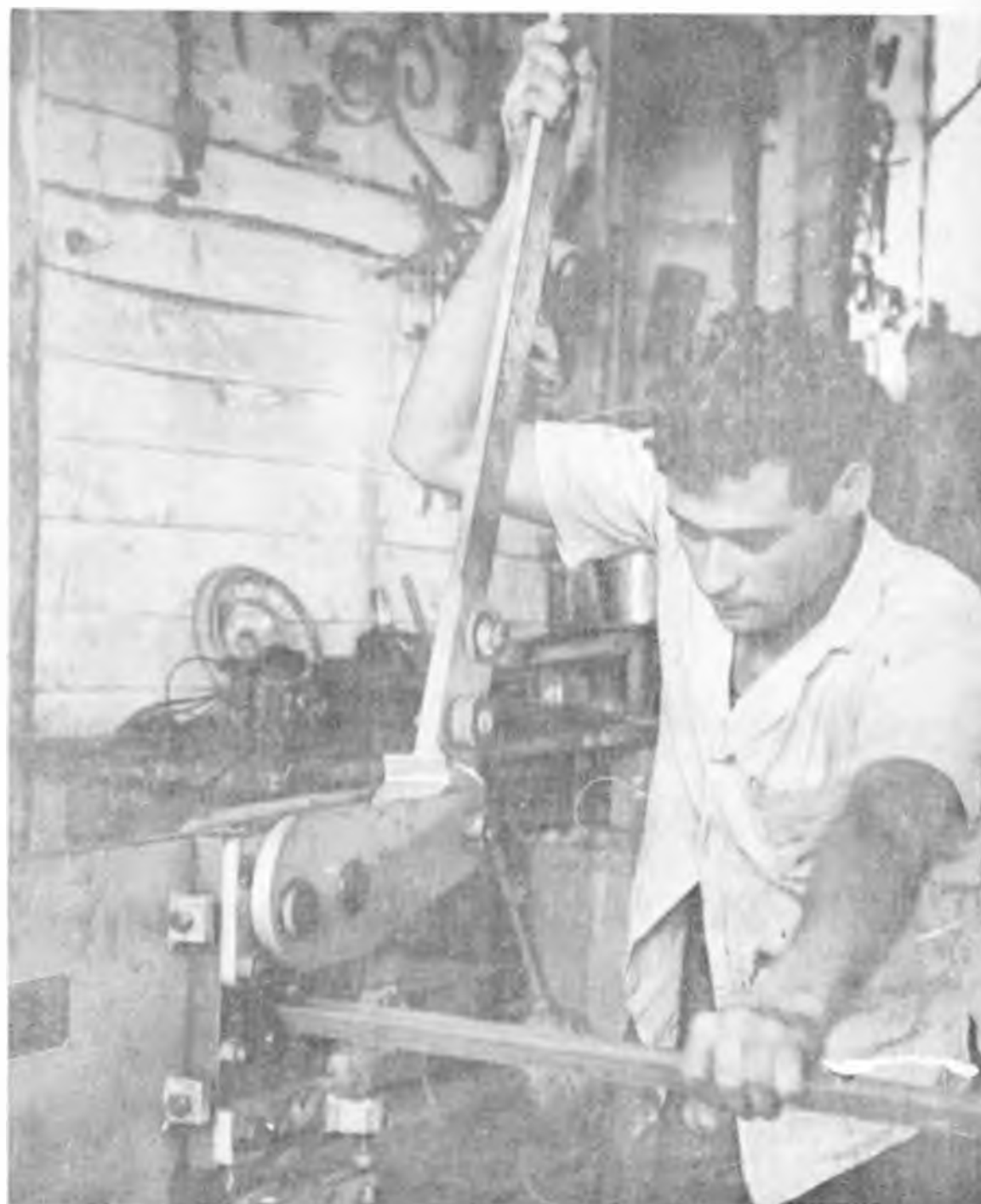
ESTA CUCHILLA O GUILLOTINA DE LA INVENCIÓN DE TRIANA CORTA LOS ANGULARES DE LAS CAMAS COMO SI FUERAN DE PAPEL.
