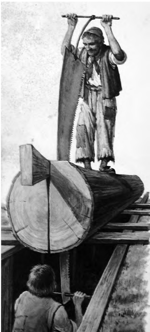
Carpinteros de ribera aserrando una toza de madera para la confección de una pieza de arquitectura naval
