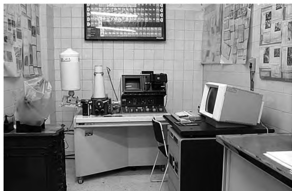
Fig. 2. Microscopio electrónico de barrido utilizado para los análisis
