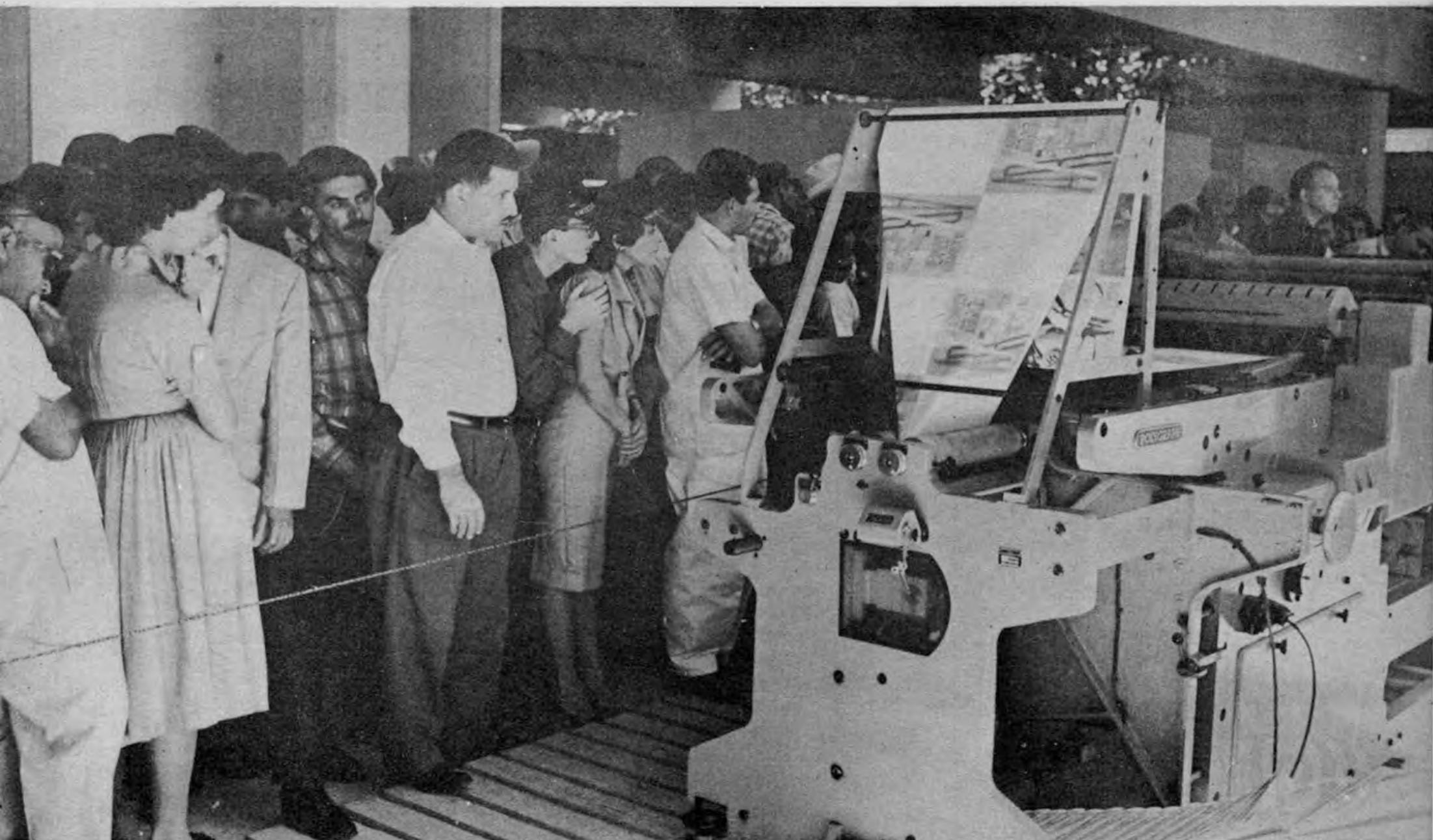
El sistema de impresión a colores por medio de los equipos Polygraph es uno de los atractivos de la Exposición Industrial de la R.D.A. Allí puede observarse el funcionamiento de esos equipos y es notable la sorpresa que se recibe al ver entrar la bobina de papel en una rotativa ultramoderna y observar salir debidamente impreso en magníficos colores doblados y cortados en pliegos.
